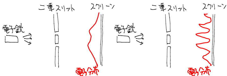
図 3: 二重スリット (左) 電子が古典的粒子であった場合に期待される観測結果 (右) 実際に観測される結果
